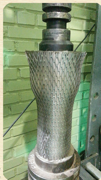
تست کارگاهی توری منبسط شونده کنترل شن
